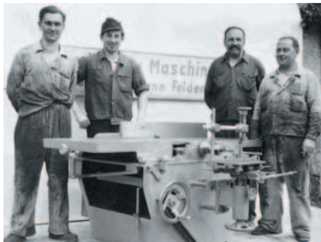
Pierwszy model obrabiarki wieloczynnościowej produkcji Feldera, ten typ maszyn stanowił trzon produkcji i przyczynił się do dynamicznego rozwoju firmy.
