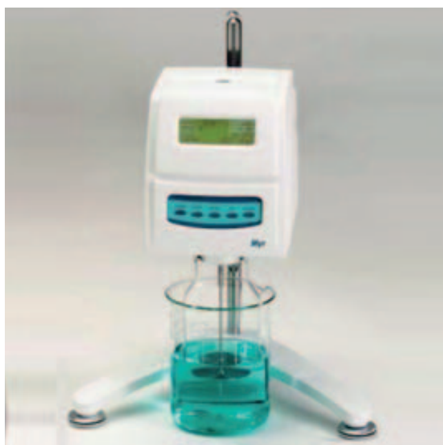
Wiskozymetr – przyrząd do pomiaru lepkości (oporu) cieczy.
