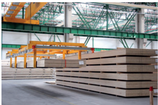
LVL ze względu na doskonałe parametry techniczne, wynikające ze sposobu skrawania i łączenia fornirów, jest idealnym budulcem zastępującym cegłę czy beton.
